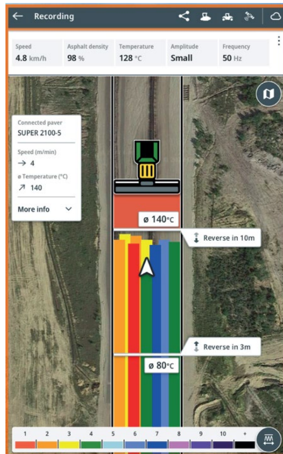
Guidage du modèle de compactage (©Wirtgen)
