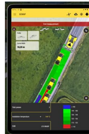
A droite : Intégration dans l'affichage de la température relevée par le finisseur (©Bomag)
