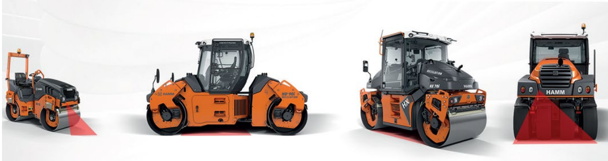
Illustration du positionnement des capteurs de température (©Wirtgen)
