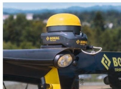
Antenne GPS sur un rouleau compacteur (©Bomag)
