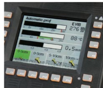
Affichage de l'énergie de compactage via EVIB sur l'écran du compacteur (©Bomag)
