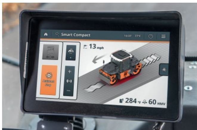
Contrôle de l'énergie de compactage et transition de la vibration à l'oscillation (©Wirtgen)
