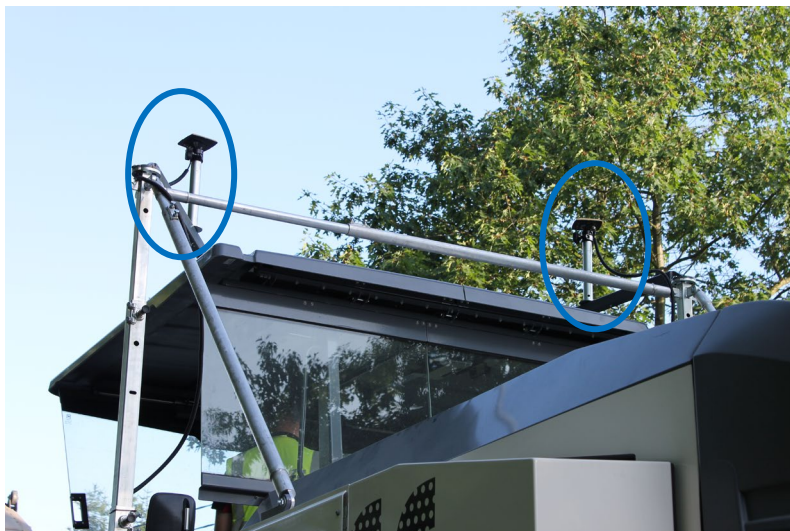
Deux antennes GPS-GNSS montées sur la fraiseuse
