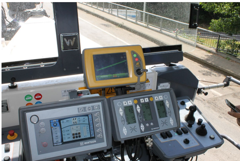
Panneau de commande avec le plan d'exécution (boîtier jaune)
