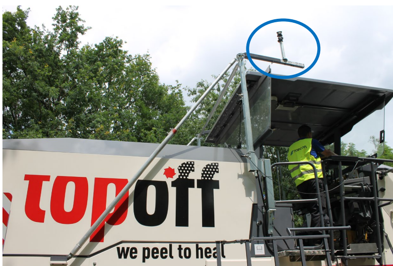
Prisme monté sur la machine
