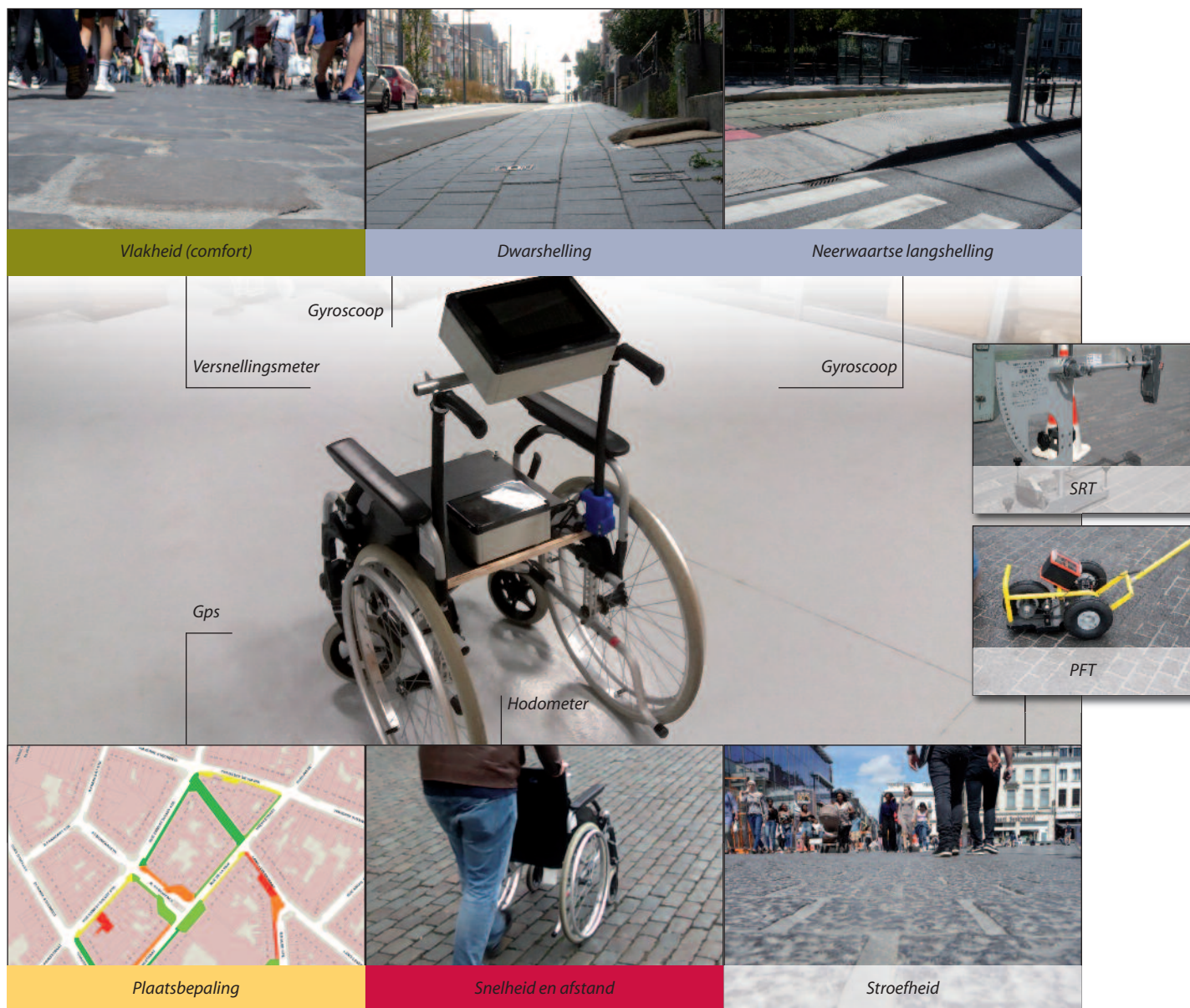
Figuur 6 – Tool in ontwikkeling (prototype 2) om de gebruikskwaliteit van voetgangersverhardingen te meten
