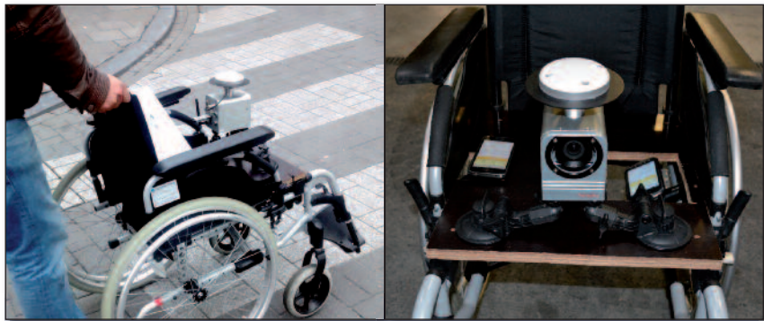
Figuur 2 – Prototype 1, met twee smartphones (+ een camera om beelden te maken)
