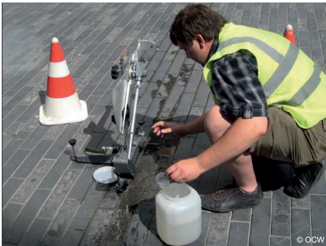
Meting van de stroefheid van een voetgangersoppervlak met behulp van de SRT-slinger
