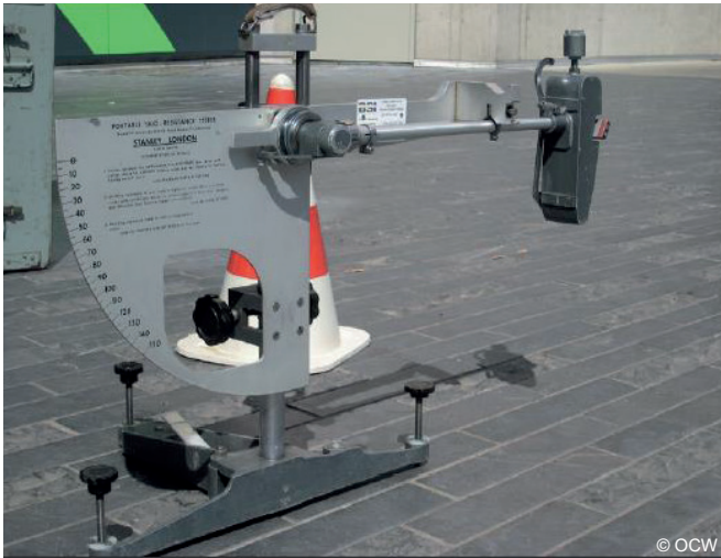
Meting van de stroefheid van een voetgangersoppervlak met behulp van de SRT-slinger
