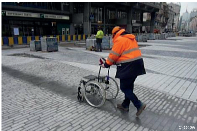
Nieuwe, door het OCW ontwikkelde uitrusting meet het comfort van voetgangersverhardingen
