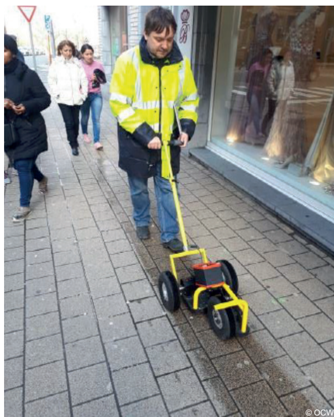
Continue stroefheidsmeting met PFT-toestel
