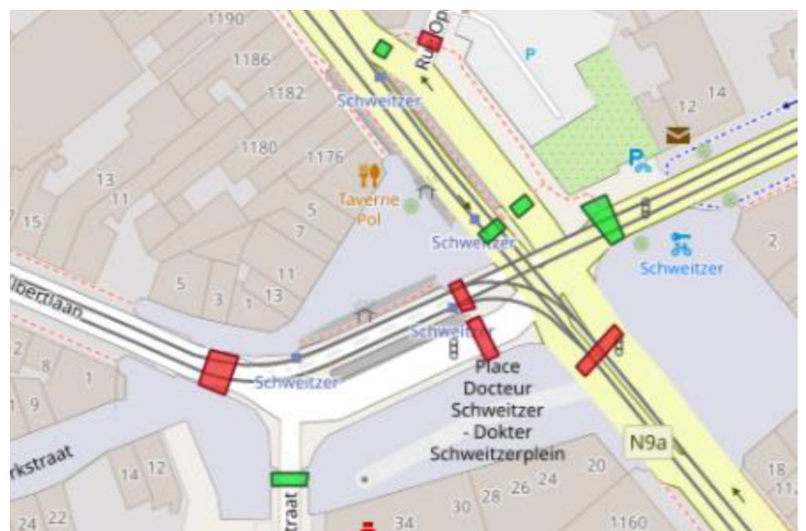
Lokalisatie van de conforme (groen) en de niet-conforme (rood) oversteekplaatsen. © OCW
