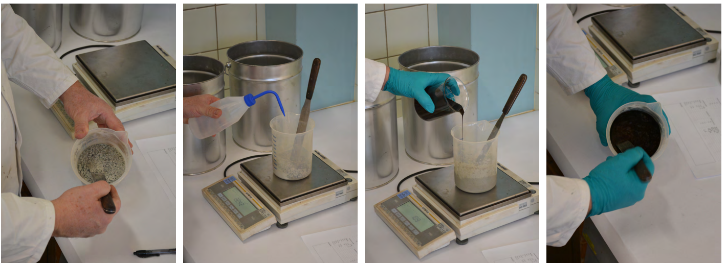
Figuur 9 – Uitvoering van de mengtijdproef volgens ISSA TB113 (deel 2) (International Slurry Surfacing Association [ISSA], 2024)
