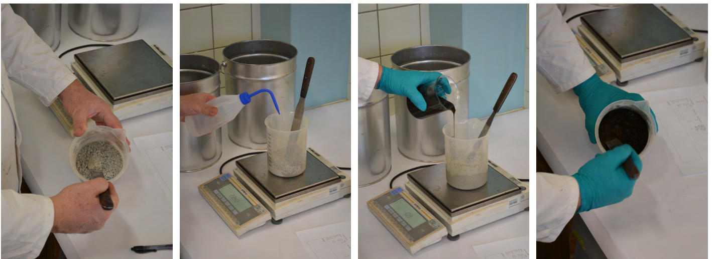
Figure 9 – Exécution de l'essai de temps de mélange selon l'ISSA TB113 (deuxième partie) (International Slurry Surfacing Association [ISSA], 2024)
