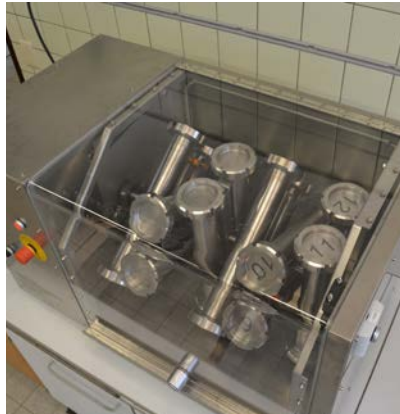
Figuur 5 – Schud-/slijtproef volgens NBN EN12274-7
