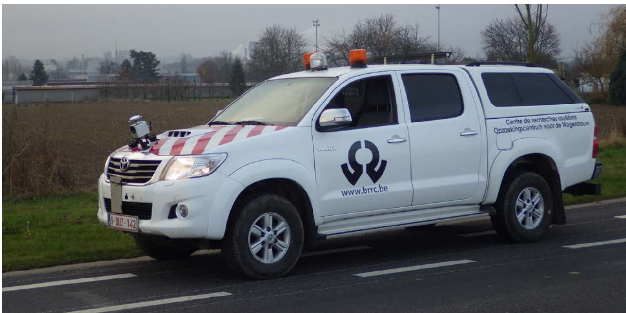
Figuur 7 – Imajbox®, om de toestand van het wegdek in beeld te brengen
