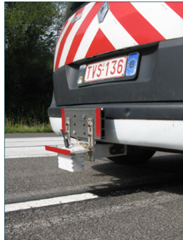
Figuur 3 – Laserprofielmeter in zijn dynamische opstelling (links; laser en camera zitten in het witte bakje) en in zijn statische opstelling (rechts)
