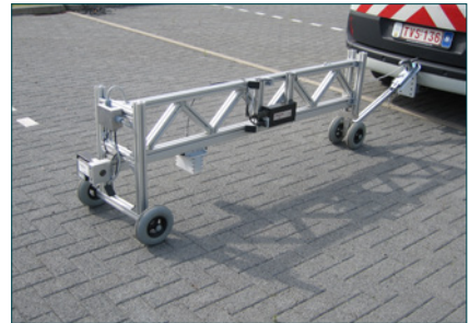
Figuur 3 – Laserprofielmeter in zijn dynamische opstelling (links; laser en camera zitten in het witte bakje) en in zijn statische opstelling (rechts)
