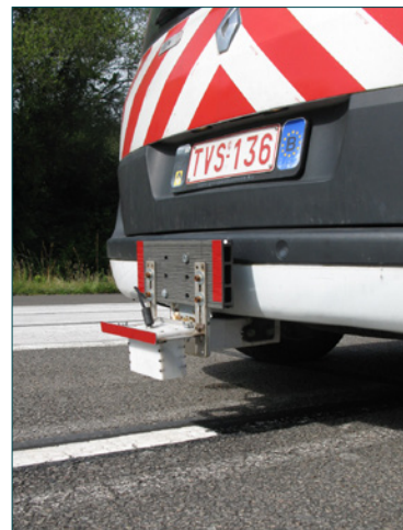
Figure 3 – Configuration dynamique d'un profilomètre laser (à gauche; le laser et la caméra se trouvent dans le petit bac blanc) et dans sa configuration statique (à droite)
