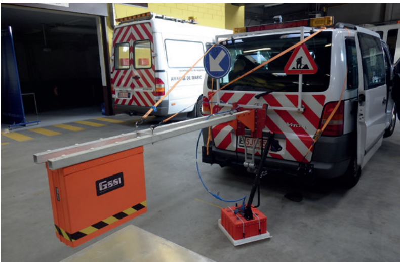
Figure 6 – Antenne aérienne et antenne de contact du CRR
