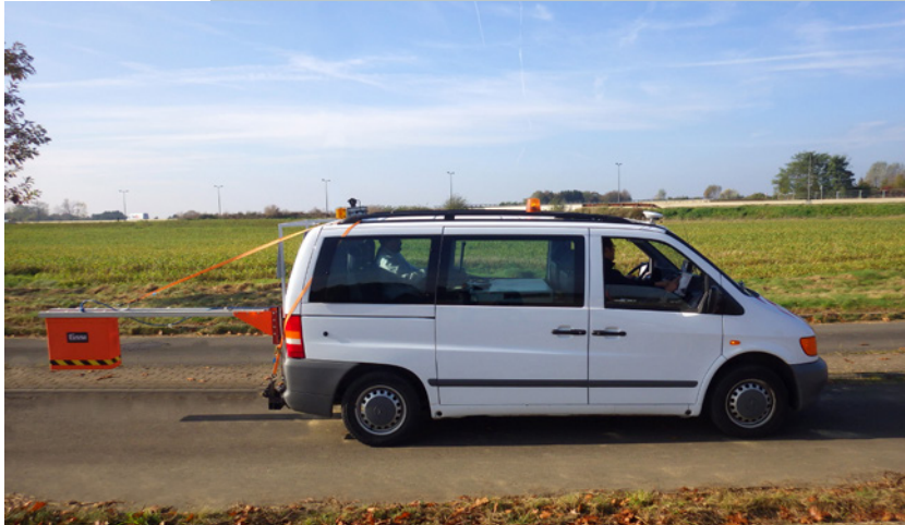
Figuur 2 – GPR-uitrusting van het OCW
