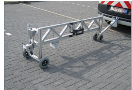
Figuur 3 – Laserprofielmeter in zijn dynamische opstelling (links; laser en camera zitten in het witte bakje) en in zijn statische opstelling (rechts)
