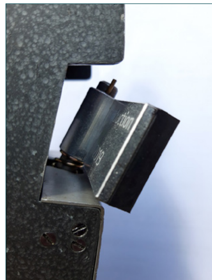
Figuur 2 – Rubberplaatje aan het uiteinde van de arm van de SRT-slinger
