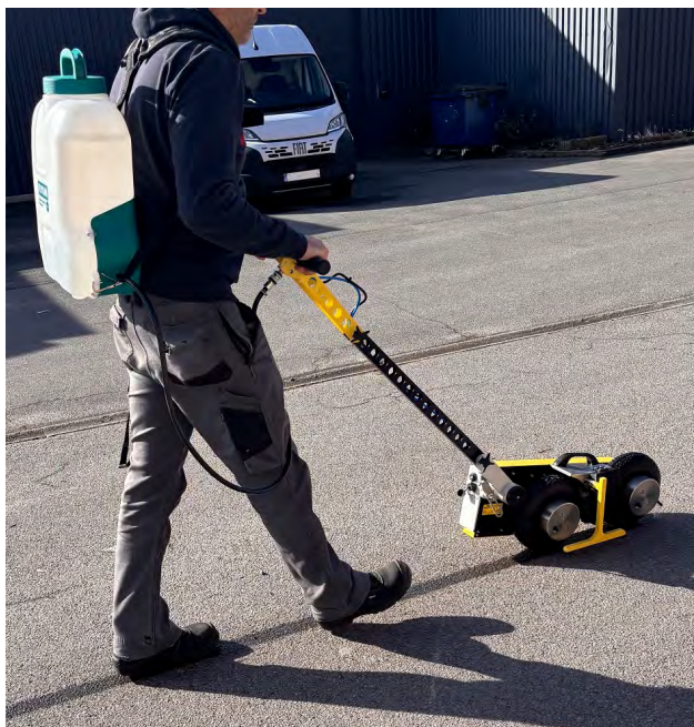
Figure 2 – T2GO Friction Tester, une méthode de mesure en continu © CRR
