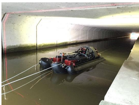
Figure 27 - Bateau sonar avec scanner laser 3D (source : Vandervalk-Degroot)
