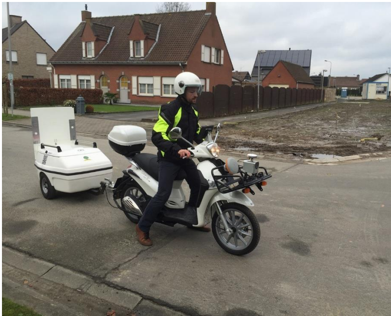
Figure 57 - Profilomètre pour pistes cyclables avec équipement (source : CRR)
