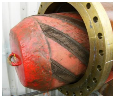
Figure 33 – Piston de nettoyage (source : Vecom)
