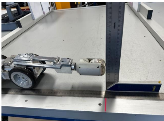
Figure 92 : La position la plus basse du pantographe (source : CRR)
