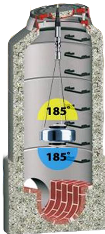
Figure 40 - Représentation schématique PANORAMO-SI System (source : IBAK)
