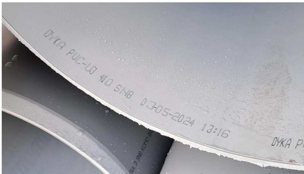
Figure 78 - Marquage du diamètre extérieur PVC-U (source: Dyka)
