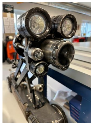
Figure 6 - Pearpoint_Camera voiture avec objectif œil-de-poisson (source : CRR)
