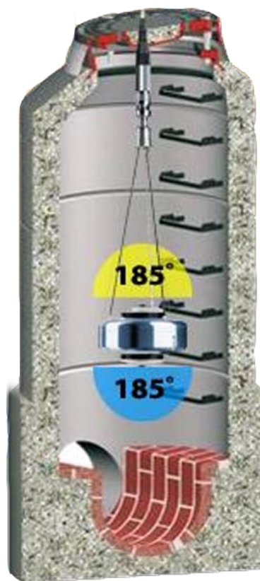
Foto 40 (Bron IBAK) Schematische voorstelling PANORAMO-SI System
