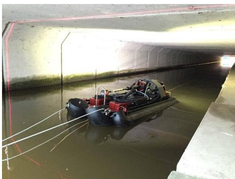
Foto 27 (Bron Vandervalk-Degroot) Sonarboot met 3D-laserscan
