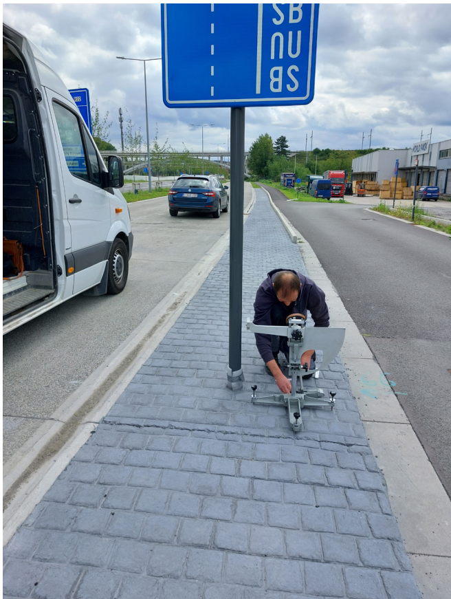
Figure 5.1 – Mesure de la rugosité sur du béton imprimé avec le pendule SRT du CRR.
