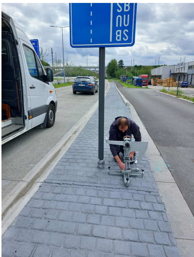
Figuur 5.1 – Meting van de stroefheid op gefigureerd beton met de SRT-slinger van OCW.
