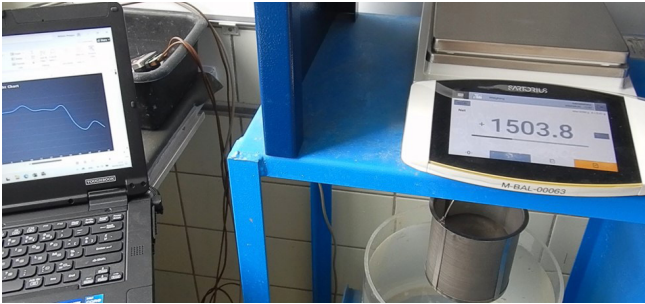
Figuur 3 – Alternatieve beproevingsmethode ter bepaling van de waterabsorptie op basis van hydrostatische weging
