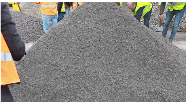
Figuur 1 - 'Hoogwaardig' betonbrekerzand afkomstig van productie van hoogwaardig (grof) betongranulaat A+.
