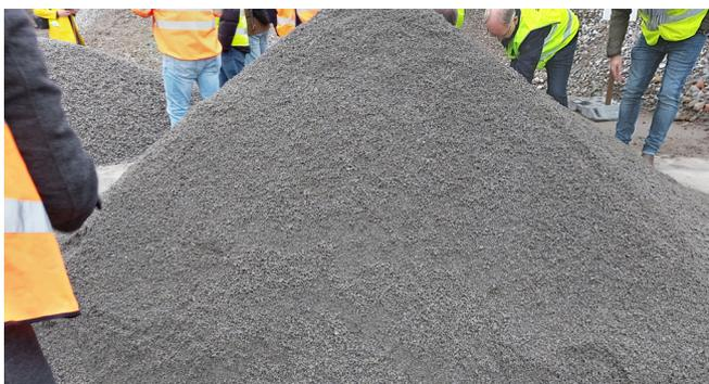
**Figure 1** – Sable de concassage de béton «de qualité supérieure» provenant de la production de gravillons de béton de qualité supérieure A+
