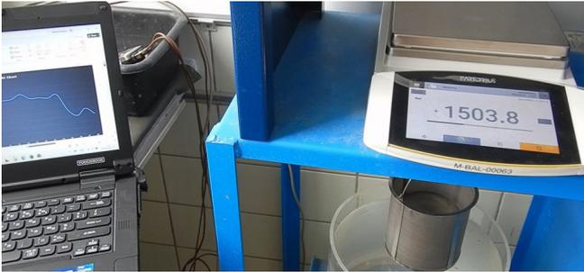
**Figure 3** – Méthode d'essai alternative pour déterminer l'absorption d'eau sur la base de la pesée hydrostatique
