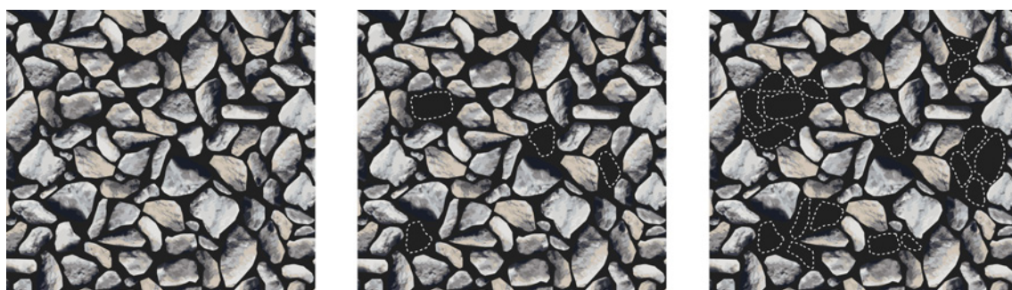
Figuur 2.1 – Schematische voorstelling : geen schade, individueel steenverlies en uitrukking
