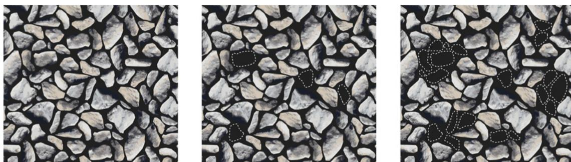
Figure 2.1 – Représentation schématique de la perte individuelle de pierres et de l'arrachement
