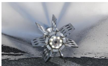
Foto 31 (Bron Sewer Robotics) Reinigingskop met ingebouwde camera
