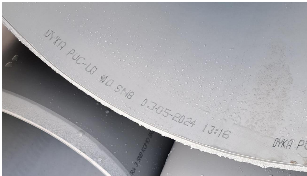
Foto 78 (Bron Dyka) Markering buitendiameter PVC-U
