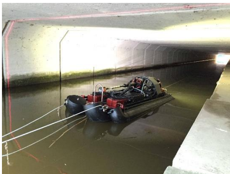
Foto 27 (Bron Vandervalk-Degroot) Sonarboot met 3D-laserscan
