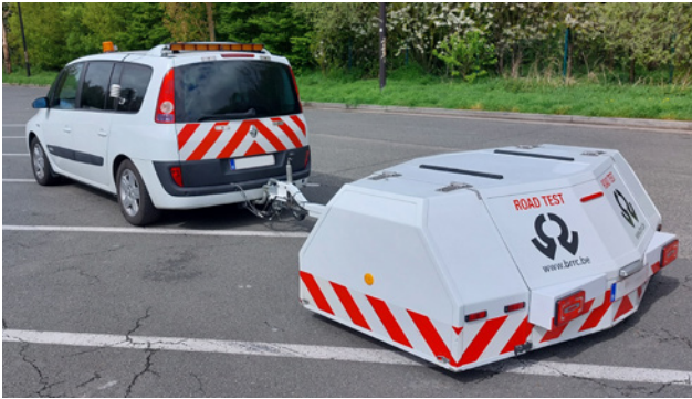
Figure 2 - Véhicule de mesure avec remorque CPX du CRR
