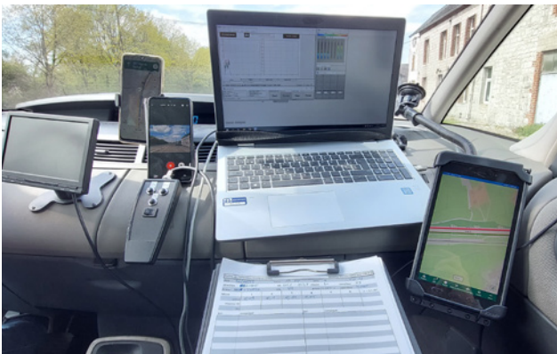
Figure 3 - Installation de l'équipement dans le véhicule de mesure pendant la mesure CPX
