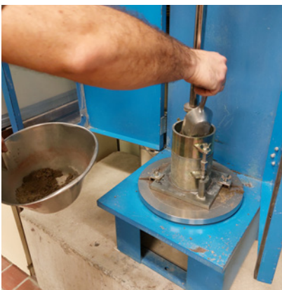
Figuur 3 – Proctorproeven uitgevoerd in laboratorium van OCW
