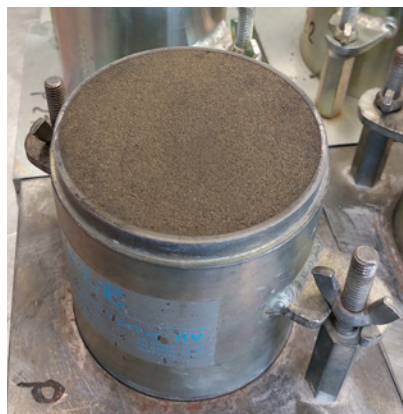
Figuur 3 – Proctorproeven uitgevoerd in laboratorium van OCW
