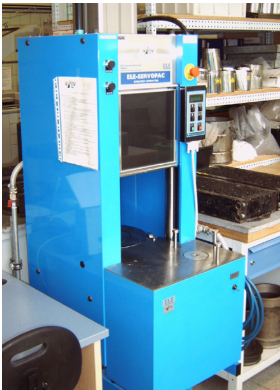
Figure A1.1 – Compacteur giratoire et moule et éprouvette après compactage
