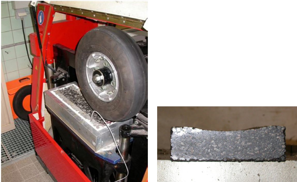
Figure A1.4 – Simulateur de trafic et mesure de la profondeur d'orniérage
