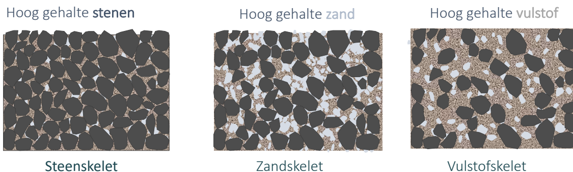
Figuur 2.1 – Illustratie van de families bitumineuze mengsels volgens soort skelet
