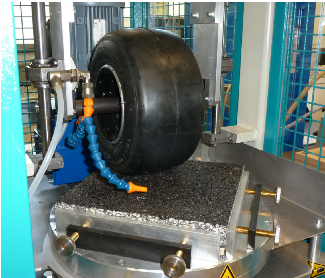
Figuur A1.8 – Rafelingsproef (Darmstadt Scuffing Device)
