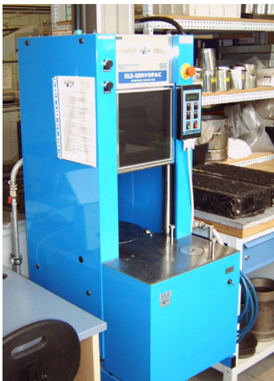
Figuur A1.1 – Gyratoroestel en mal en proefstuk na verdichting
