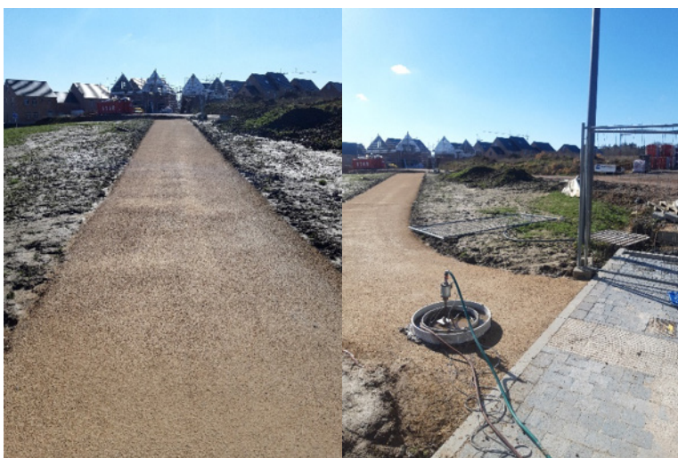
Figuur 10 – Doorlatendheidsmetingen met de dubbele-ringproef van OCW op de site in Waver.
