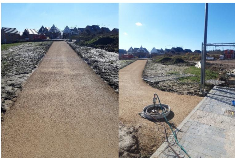
**Figure 10** – Mesures de perméabilité avec l'essai double anneau du CRR sur le site de Wavre.
