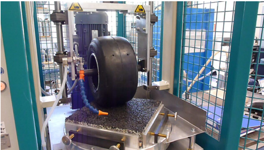
Figure 1 – L'équipement de type DSD pour évaluer le plumage au CRR (De Visscher & Vanelstraete, 2015)
