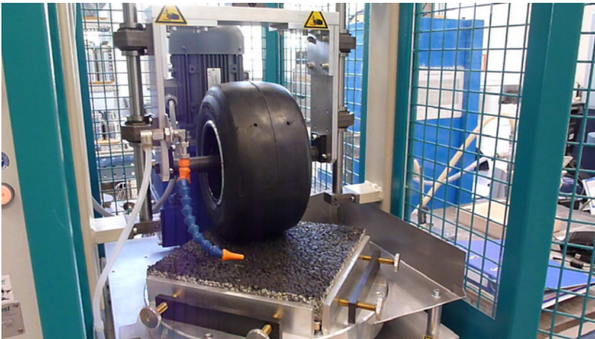
Figuur 1 – Darmstadt Scuffing Device rafelingstester bij OCW (De Visscher & Vanelstraete, 2015)
