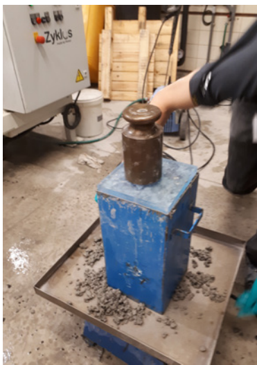
Figuur 4 – Proeven ter bepaling van de verwerkbaarheid van poreus beton met aangepaste "Waltz-proef" en het effect van colloïdaal poeder (compo 1)
