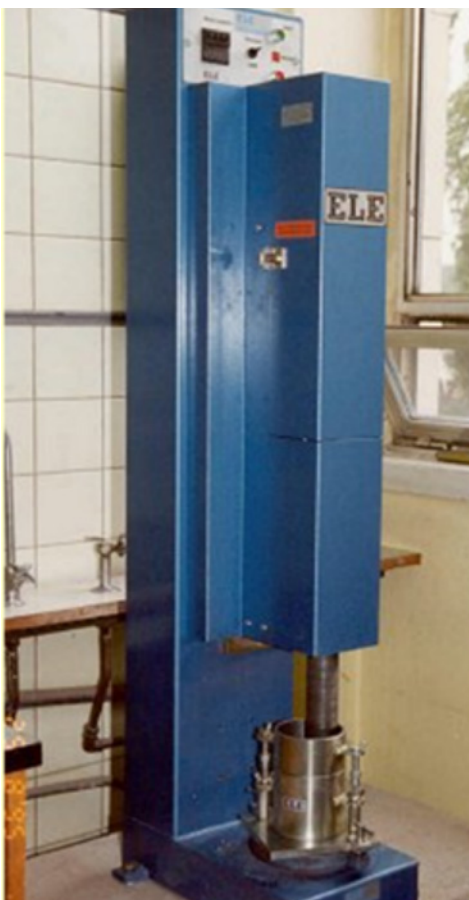
Figuur 2 – Apparatuur voor Proctorverdichting en voorbeeld van Proctorkrommen
