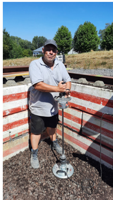
Figuur 11 – Gammadensiteitsmetingen (links) en Duitse dynamische plaatproef (rechts) in de proefsleuf
