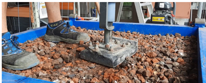
Figuur 4 – Verdichting van de bomengranulaten (trilhamer 30 kg)
