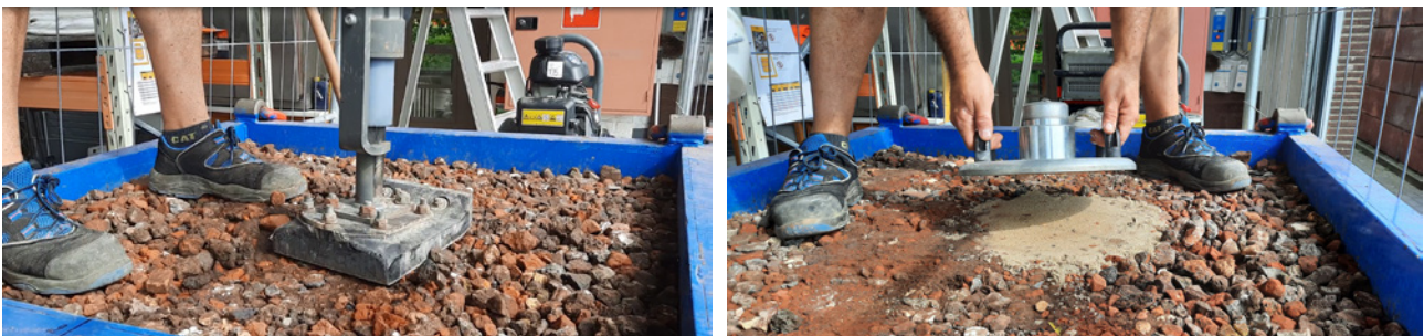
Figuur 8 – Verdichting en dynamische plaatproef (0/40 B3bis) – tweede proef
