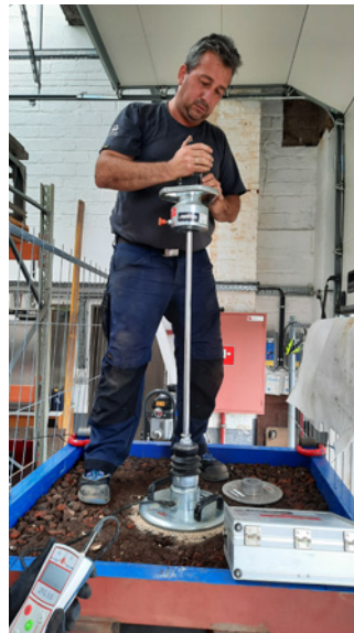
Figuur 7 – Dynamische plaatproef (B3bis) – eerste proef
