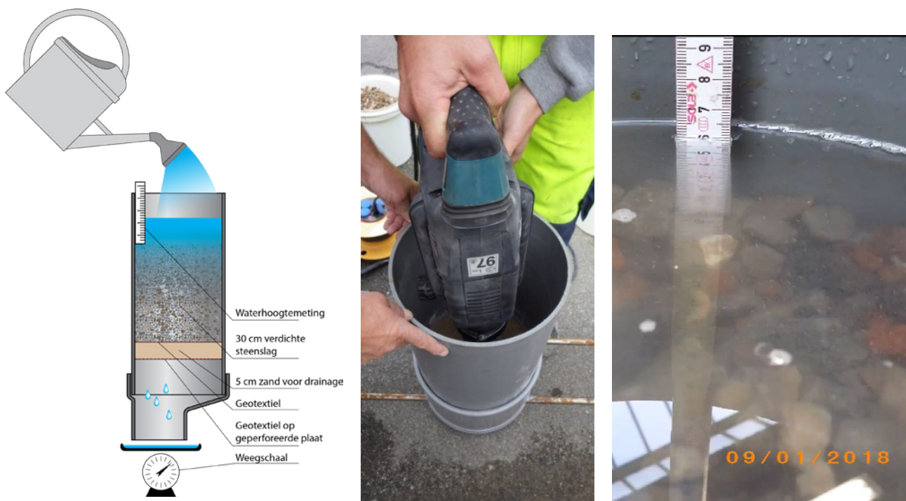
Figuur 1 – Principe van de kolomproef ter bepaling van de waterdoorlatendheid (Van der Wielen & Grégoire, 2018)
