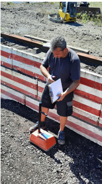
Figuur 11 – Gammadensiteitsmetingen (links) en Duitse dynamische plaatproef (rechts) in de proefsleuf
