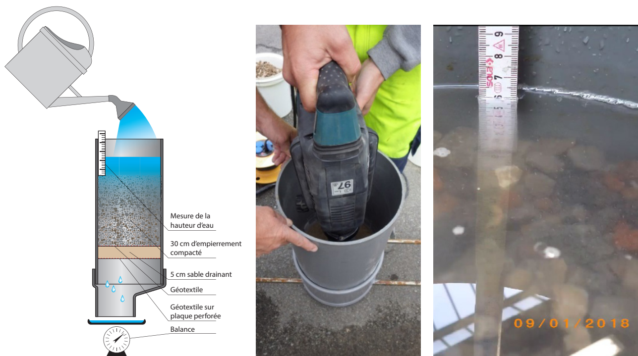
Figure 1 – Principe de l'essai en colonne pour déterminer la perméabilité (Van der Wielen & Grégoire, 2018)
