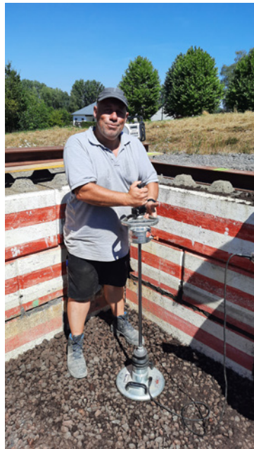
Figure 11 – Mesures au gammadensimètre (à gauche) et essai à la plaque dynamique allemande (à droite) dans la tranchée expérimentale
