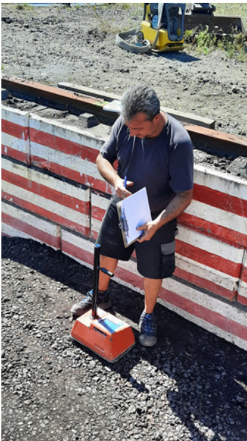
Figure 11 – Mesures au gammadensimètre (à gauche) et essai à la plaque dynamique allemande (à droite) dans la tranchée expérimentale
