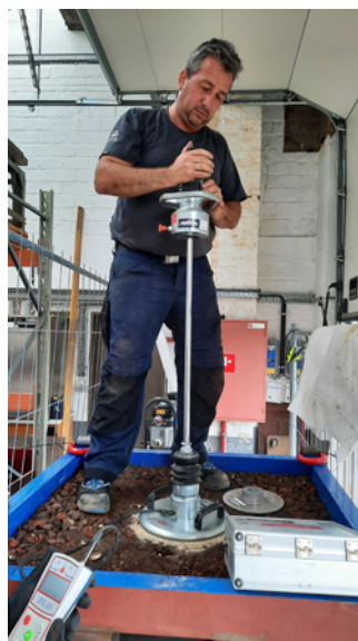
Figure 7 – Essai à la plaque dynamique (B3bis) – premier essai
