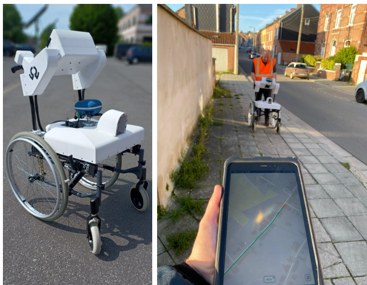
Figuur 2 – De meetstoel is gekoppeld aan een tablet waardoor aanvullend onderzoek op het terrein mogelijk is
