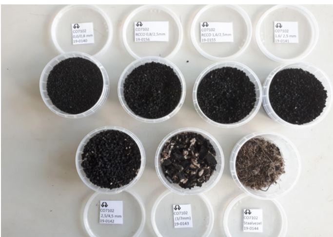
Figuur 1 – Beschikbare materialen afkomstig van afvalbanden uit België (RRO) [R0-0,8 mm – R0,8-2,5 mm – R1,6-2,5 mm – R2,5-4,5 mm – “Cowhouse” 3/7 mm – gerecycleerde staalvezels]
