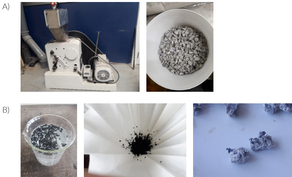
Figuur 8 – Proeven op laboratoriumschaal om recycleerbaarheid van rubberbeton na te gaan: a) labobreker beschikbaar bij Colas met resulterend gebroken rubberbeton; b) proeven bij OCW om het aandeel “losse” en “gebonden” rubberdeeltjes te bepalen
