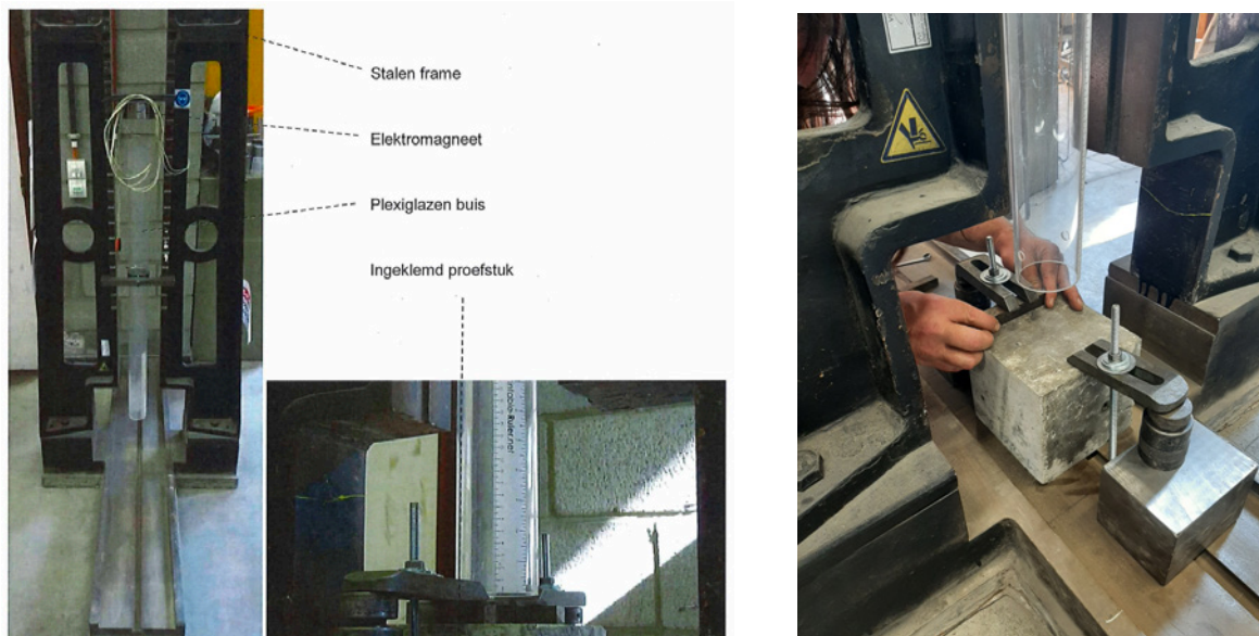
Figuur 5 – Impactproeven op kubussen met zijde 15 cm volgens (Snoeck et al., 2018)
