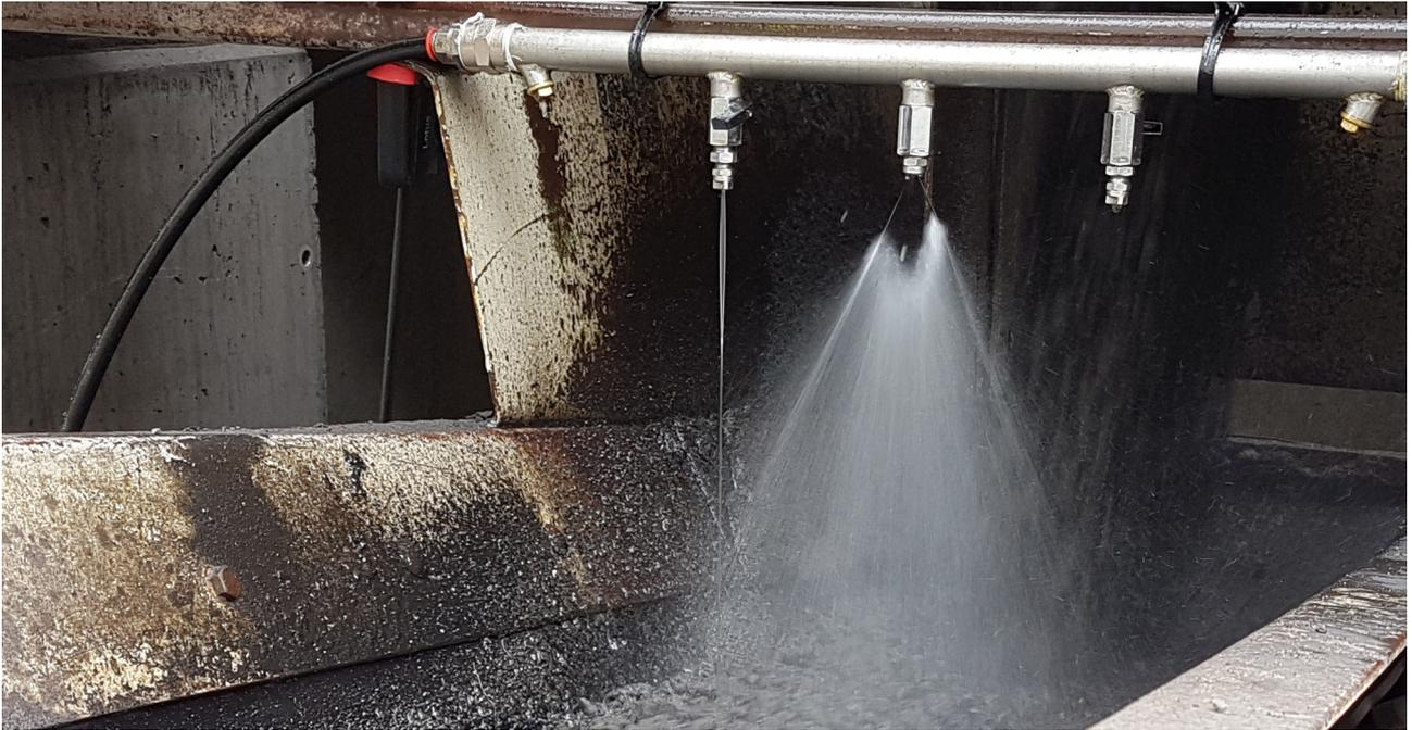
Ajout d'un produit régénérant aux agrégats d'enrobés bitumineux lors de la production d'enrobé recyclé
