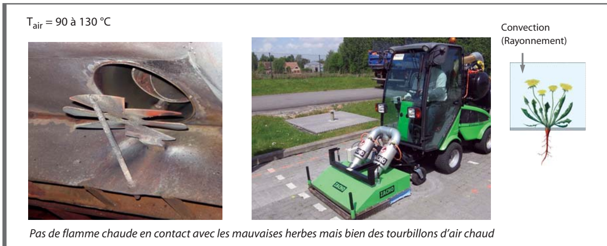
Figure 4.6 Principe de fonctionnement d'un brûleur à air chaud. A gauche: plaque à jet hélicoïdal. Au milieu: brûleur avec ventilateur puissant intégré.
