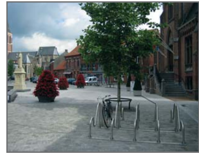
Figure 3.8 Éviter un revêtement semi-ouvert sous le mobilier urbain et/ou choisir le mobilier en fonction de l'entretien futur (obstacles amovibles, mobilier déplaçable)
