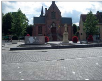
Figure 3.8 Éviter un revêtement semi-ouvert sous le mobilier urbain et/ou choisir le mobilier en fonction de l'entretien futur (obstacles amovibles, mobilier déplaçable)
