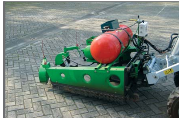
Figuur 4.1 Onkruidbestrijding op een verharding van betonstraatstenen
