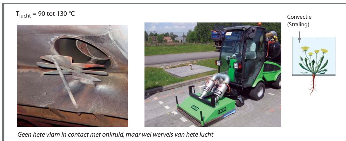
Figuur 4.6 Werkingsprincipe van een heteluchtschroeier. Links: de wervelplaat. Midden: schroeier met een krachtige, opgebouwde ventilator.
