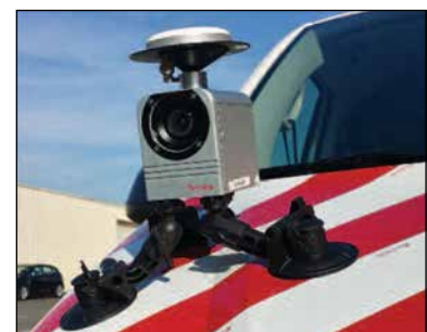
Figure 1.23 – Véhicule de mesure équipé d'un système IMAJBOX®
