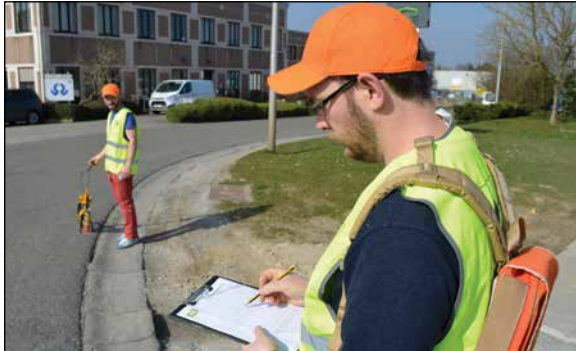
Figure 1.15 – Inspection visuelle réalisée à pied à l'aide d'un formulaire standard d'inspection
