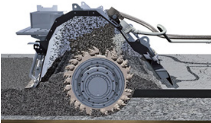
Figuur 4 – Dwarsdoorsnede freesrol en mengeenheid in situ recycler (Bron: Wirtgen)
