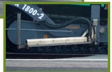
Figuur 10 Asfaltspreidmachine met ingebouwde sproeibalk en een initiële emulsieopslagcapaciteit van 2 000 l
