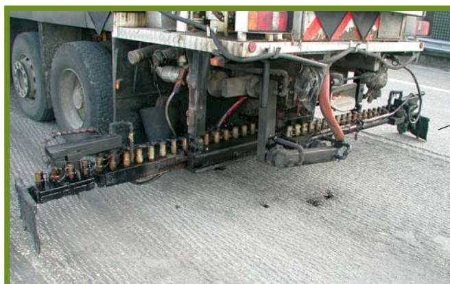
Figuur 14 Sproeimachine met een afscherende staalplaat aan de uiteinden van de sproeibalk
