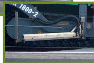
Figure 10 Exemple de finisseur à rampe intégrée (capacité initiale de 2 000 litres d'émulsion)
