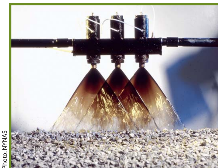
Figure 11a Jet d'émulsion en forme de lame plate
