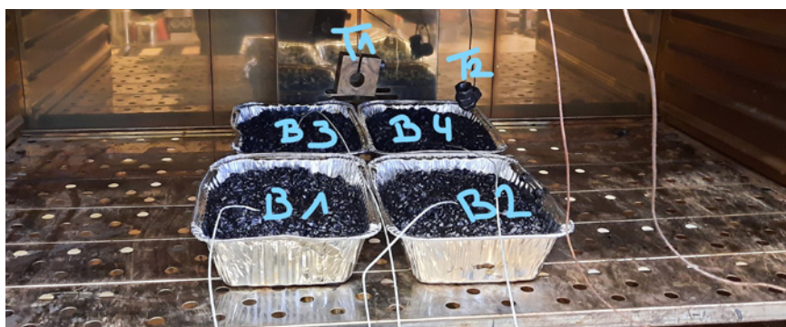
Figure 2 - Détermination des courbes indicatives pour la procédure de réchauffement: barquettes d'asphalte coulé et sondes thermiques pour l'enregistrement des températures au cœur des mélanges et dans l'étuve pendant le réchauffement
