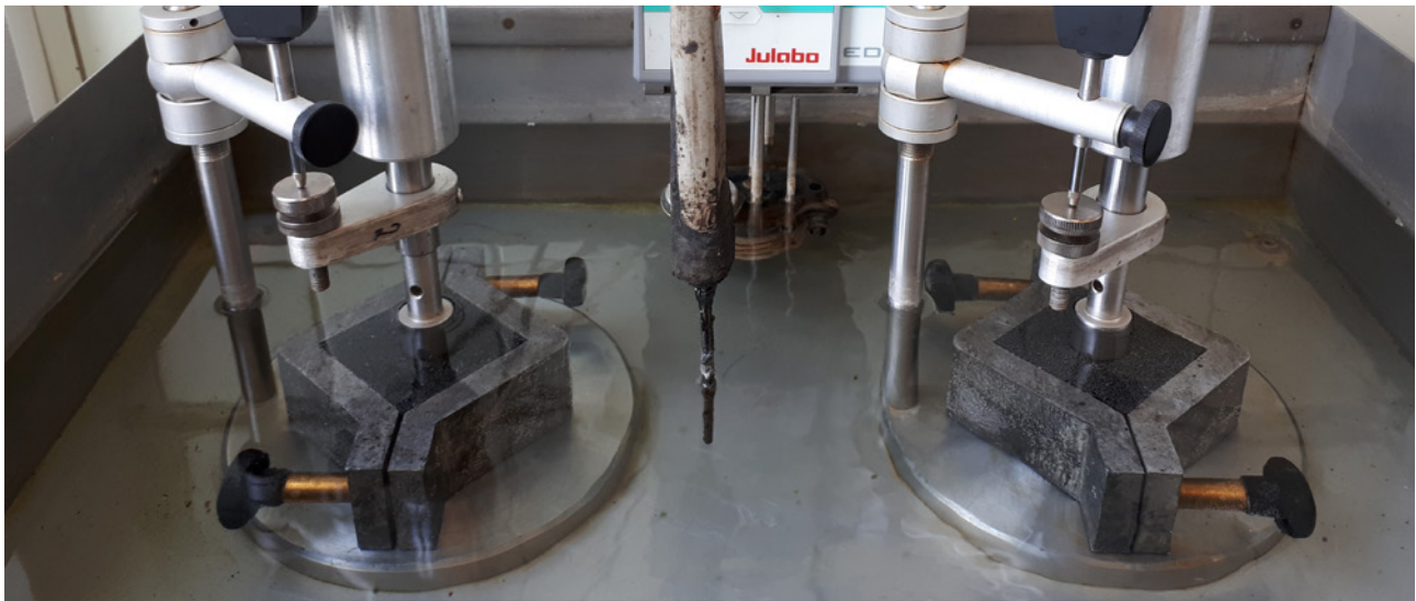
Figure 1 – Appareil d'indentation du CRR avec des éprouvettes cubiques
