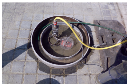
Waterdoorlatendheid van waterdoorlatende bestratingen (in situ): dubbele-ringproef
