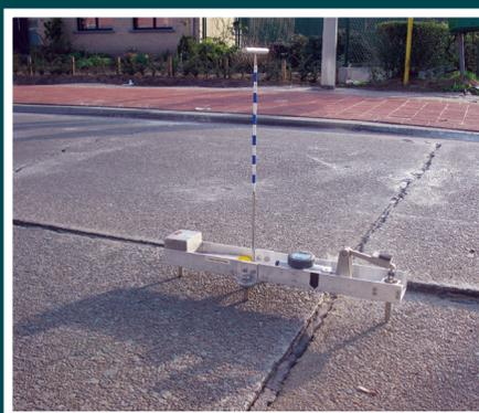
Mesure du battement des dalles en béton à l'aide du faultimètre
