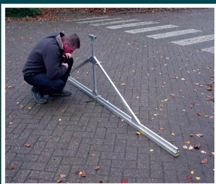
Mesure de la planéité à l'aide de la règle de 3 m
