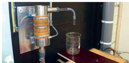
Perméabilité à l'eau du béton maigre drainant (en laboratoire): Qualiroutes – CME 52.21 (méthode à niveau constant)
