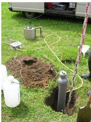
Perméabilité à l'eau du sol (in situ): essai open-end
