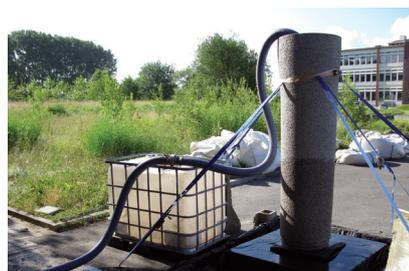
Perméabilité à l'eau des tuyaux poreux: PTV 104, § 6.1
