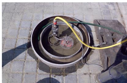
Perméabilité à l'eau des pavages drainants (in situ): essai double anneau
