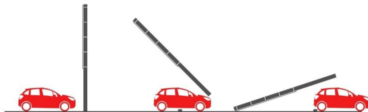
Figuur 2 – Bij de aanrijding breekt het systeem af (NS). Het voertuig wordt weinig of niet vertraagd (NE).
