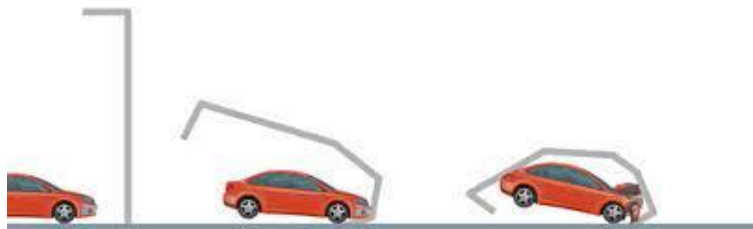
Figure 1 – Le système se replie autour du véhicule qui entre en collision (NS) et le ralentit (HE).
