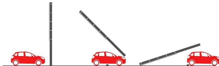
Figure 2 – Le système se rompt à l'impact (NS). Le véhicule est peu, voire pas ralenti (NE).
