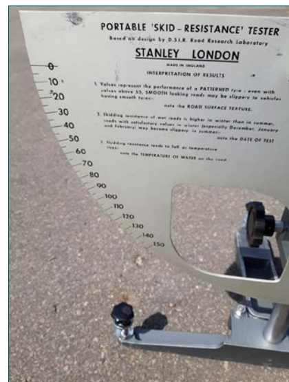
Figuur 4 – Arbitraire schaal van de SRT-slinger (Pendulum Test Value, PTV)
