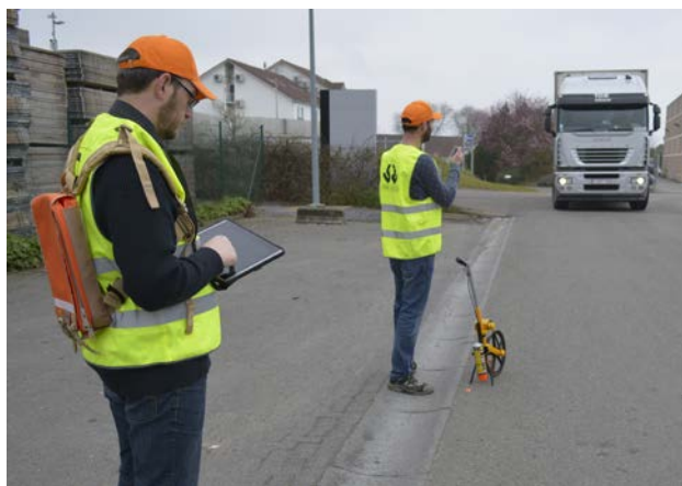
Figure 1 – Inspection à pied au moyen d'une application numérique sur tablette
