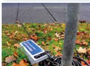
Verkeersanalyse met pneumatische telsingangen
