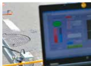
Elektromechanische profielmeter met laser (EPML)
