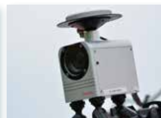
Imajbox® voor mobile mapping
