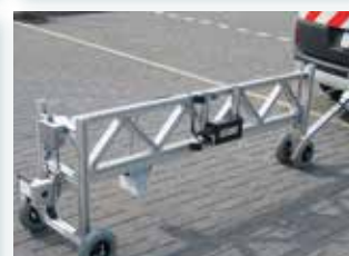
Laserprofielometer in zijn statische opstelling
